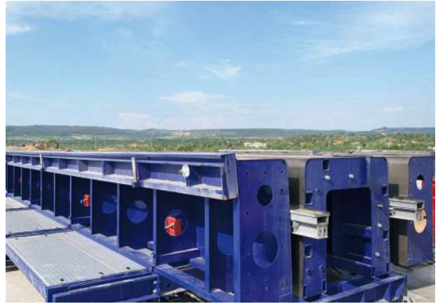
Moule avec ouverture hydraulique et réglage hydraulique de la hauteur des nervures.
