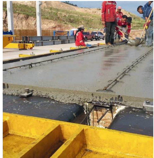
Moule avec ouverture hydraulique et réglage hydraulique de la hauteur des nervures.
