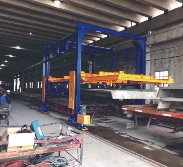
Équipement automatique pour soulever des plaques.
