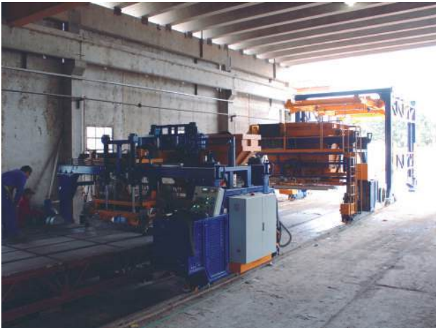
Équipement automatique pour soulever des plaques.
