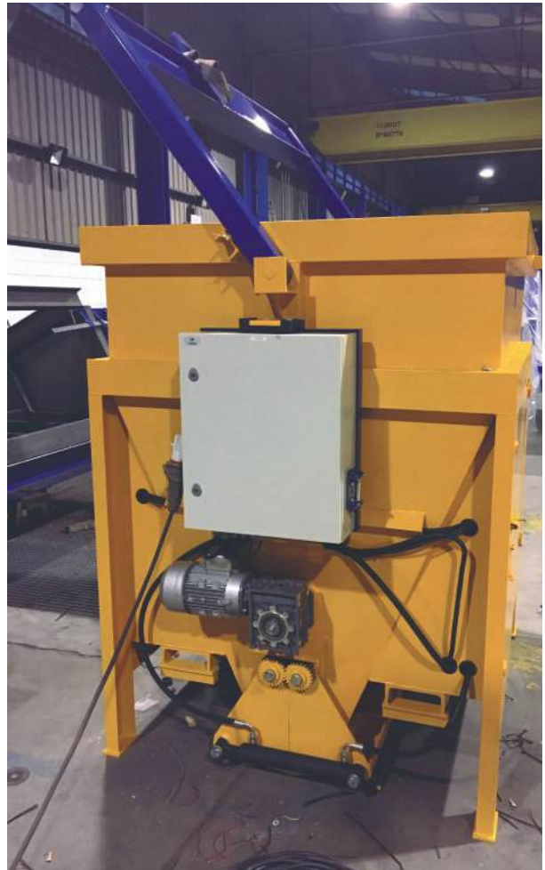
Détail de la benne avec agitateur.
