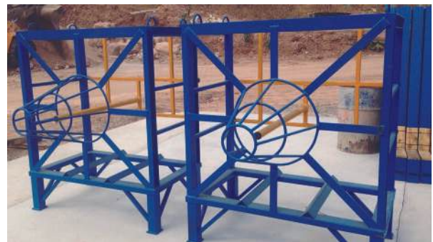
Caja dispensadora de cables para tensado.
