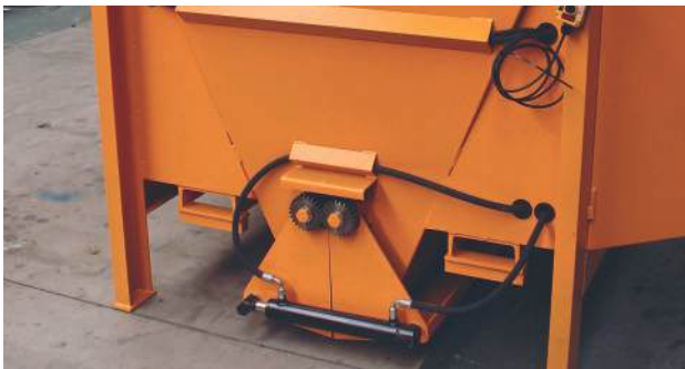
Detalle del sistema de apertura hidráulico.
