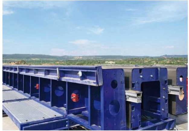
Molde con apertura hidráulica y ajuste hidráulico de altura de costilla.
