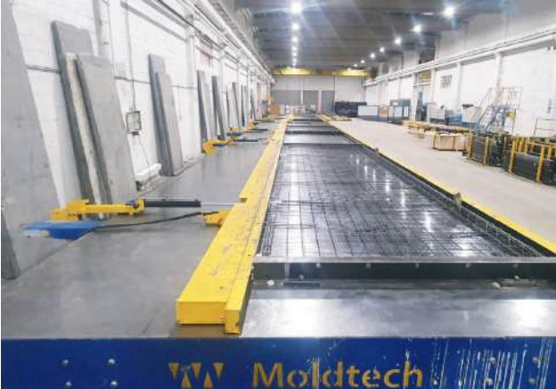
Mesas basculantes con regulación superior
