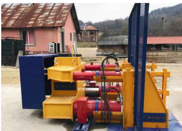
Máscara inferior y superior activa con sistema de seguridad.
