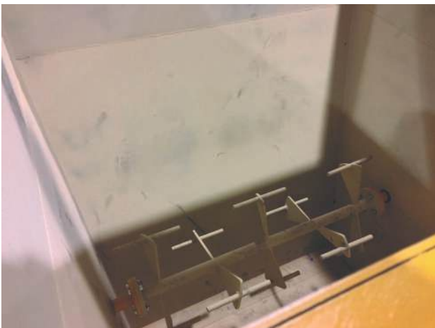
Detalle agitador en interior de cuba.
