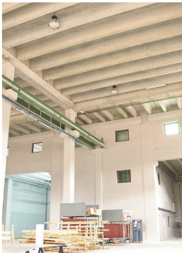
Nave industrial con placa TT para cubiertas
