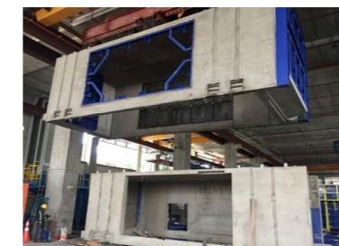
**Noyau rétractable hydraulique MOLDTECH**
